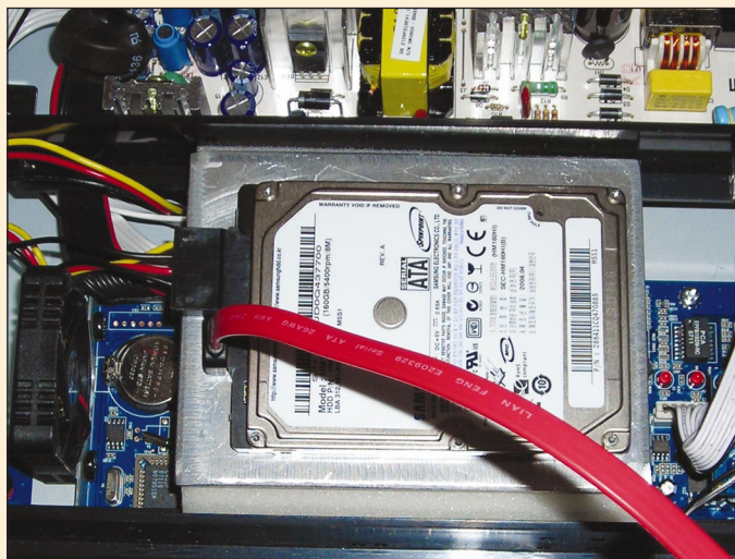
Niewielka waga powoduje, że tak zamontowany dysk trzyma się wystarczająco sztywno, a gąbka dodatkowo tłumi i tak niewielkie już wibracje.
