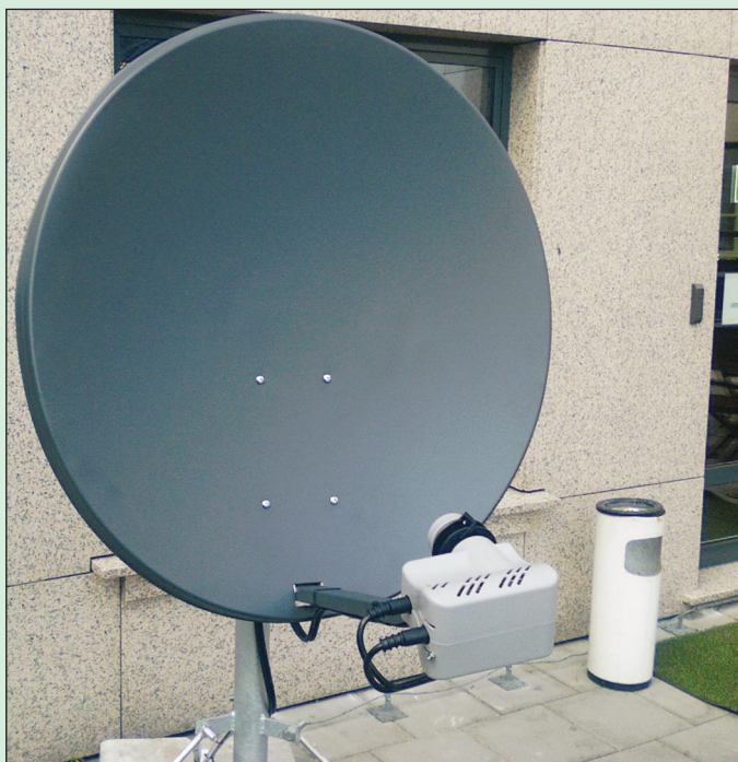
Zdjęcie prezentuje zmontowaną i zainstalowaną na stojaku antenę wraz z podłączonym i ustawionym do pracy konwerterem.
