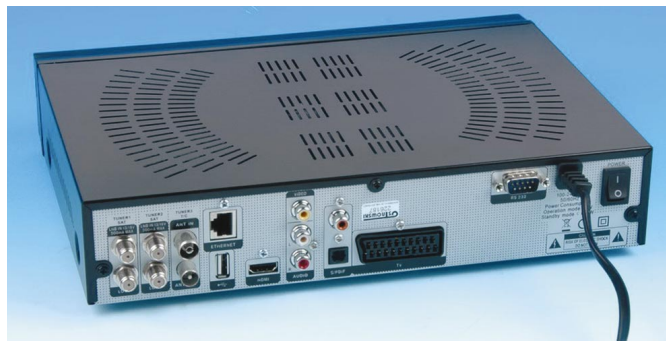
Panel tylny stanowi jedną całość z podstawą (chassis) odbiornika. Wykonane zostały ze srebrnej blachy (zdj. Satsklep).
