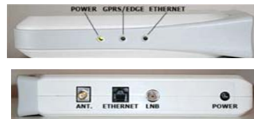
Modem satelitarny (odbiornik + wbudowany modem GPRS/EDGE) wyposażony w interfejs Ethernet (Plug & Play)
