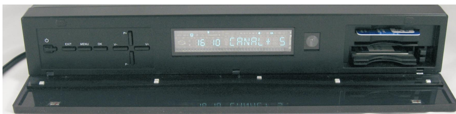
Zestaw elementów sterujących i gniazd pojawia się dopiero po odchyleniu osłony przedniego panelu
