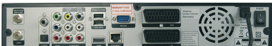
Kształt otworów wentylacyjnych sugeruje, że odbiornik jest chłodzony przez wentylator. Ale w środku wentylatora nie ma.
