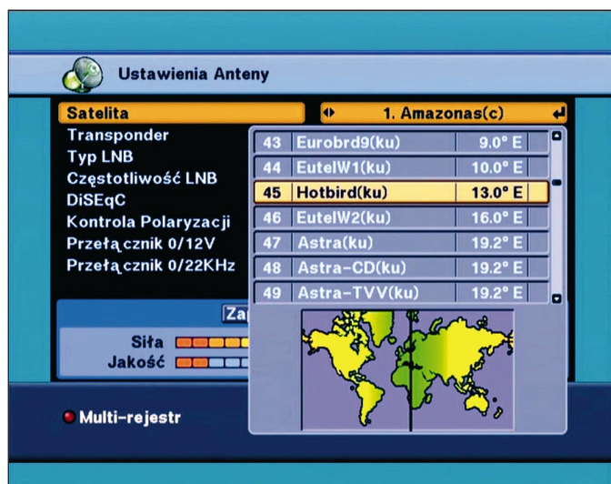
Wybór satelity sygnalizowany jest przesuwającą się po mapie kreską, obrazującą położenie na orbicie geostacjonarnej
