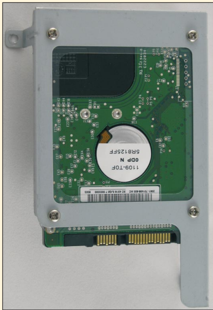
Zainstalowany na wsporniku dysk jest odwrócony „do góry nogami”
