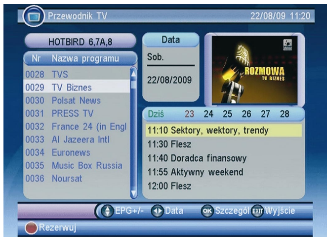
Z poziomu EPG można zarezerwować program. Wówczas dane do timera wprowadzone zostaną bez potrzeby wpisywania ich ręcznie.
