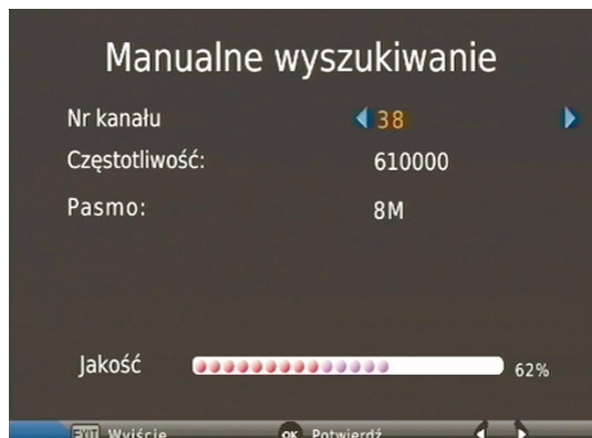
Przy skanowaniu ręcznym można wybrać numer kanału, lub wpisać częstotliwość w MHz.
