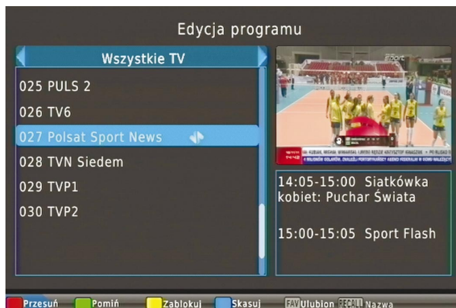
Edycja listy kanałów umożliwia swobodne przenoszenie i kasowanie wybranych pozycji. Ponowne skanowanie zmienia jednak ustawienia kolejności wprowadzone przez użytkownika i listę trzeba układać od nowa. Na razie kanałów naziemnych nie jest wiele, więc to nie jest nadmiernie dokuczliwe, ale przed pojawieniem się kolejnych multipleksów warto ustawieniom użytkownika nadać większy priorytet.
