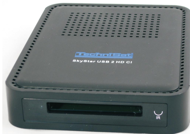
Na przedniej ścianie (jeśli to tak można nazwać) umieszczono wlot gniazda dla modułu CI, a obok niego diodę sygnalizującą pracę karty.
