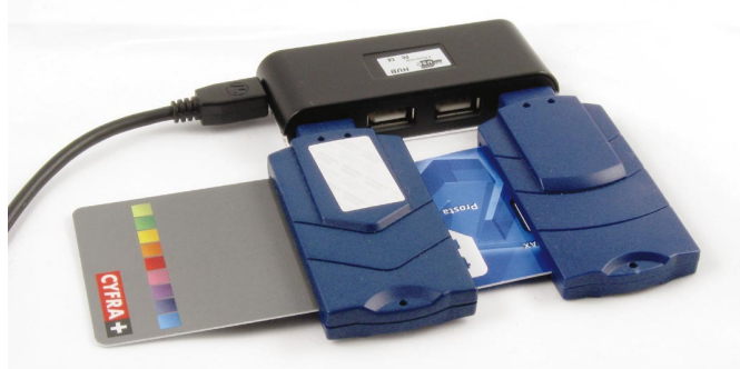
Hub nr 1, aktywny, dobrej jakości, ale jego konstrukcja uniemożliwia bezpośrednie podłączenie więcej niż dwóch czytników. W takim przypadku i tak jedna karta zachodzi za drugą.
