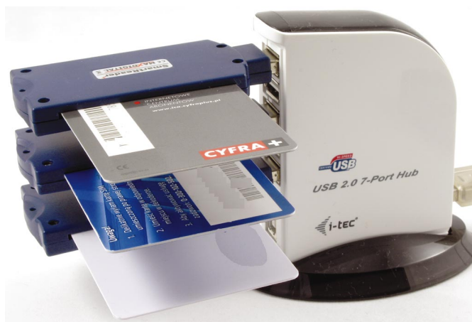
Hub nr 2. Gniazda tego huba pewnie trzymają wtyki czytników. Podstawa gwarantuje odpowiednią stabilność, a zasilacz zapewnia wystarczającą wydajność. Niestety, porty są tak blisko siebie, że nie da się wykorzystać wszystkich.
