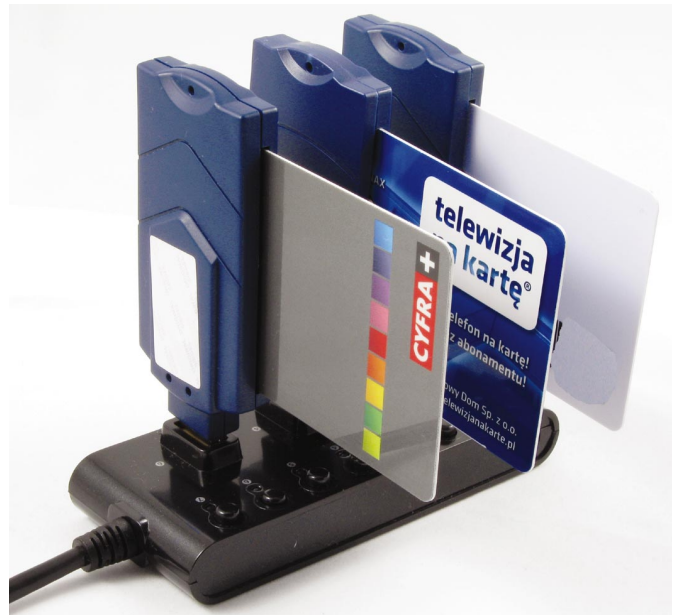
Hub nr 3. Czytniki „na stojąco” są bardziej stabilne, jest wystarczająco dużo miejsca między portami, niestety, w ulotce tego huba nie ma informacji na temat ochrony przeciwprzepięciowej portów.
